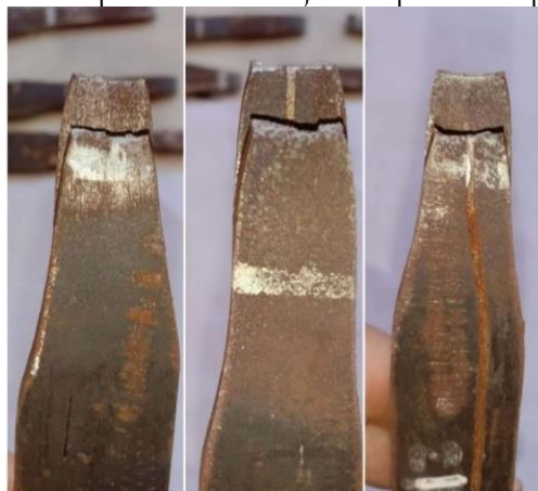
Gambar 4. Patahan spesimen hasil uji tarik pada arus pengelasan 80 A
