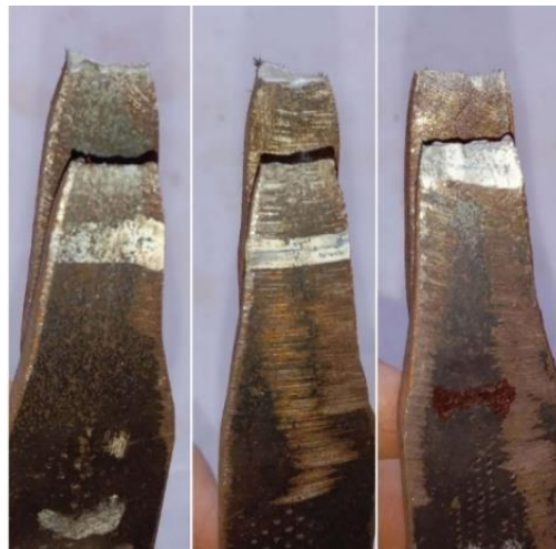
Gambar 5. Patahan spesimen hasil uji tarik pada arus pengelasan 85 A
