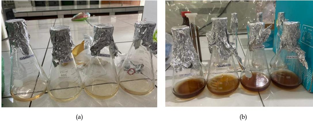
Gambar 1. Hasil sintesis nanopartikel perak (a) sebelum dipanaskan (b) setelah dipanaskan dan d Diamkan selama 6 hari
