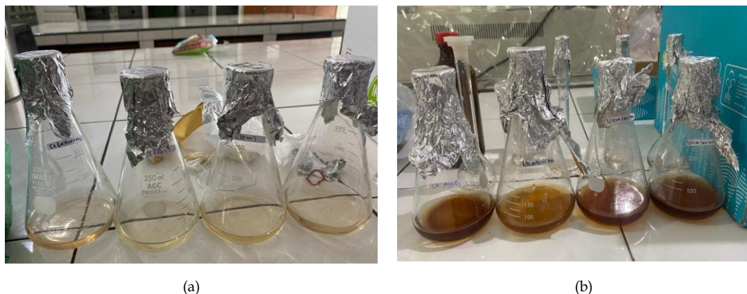
Gambar 1. Hasil sintesis nanopartikel perak (a) sebelum dipanaskan (b) setelah dipanaskan dan dibiarkan selama 6 hari
