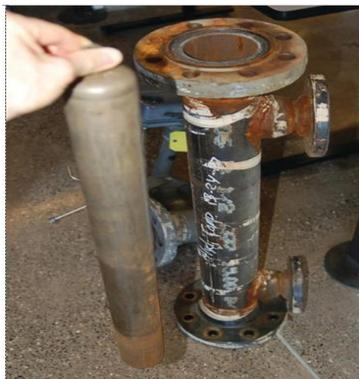
Gambar 1 Batang *Displacer*
