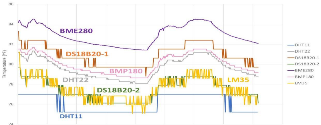
Gambar 6 Sensor DHT11 dan Grafik performa sensor DHT11
