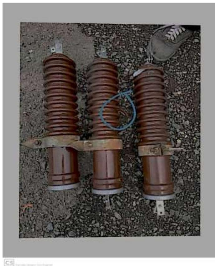
Gambar 5. Kerusakan pada *Lightning arrester*
