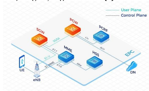
Gambar 2.1 Infrastruktur Teknologi Long Term Evolution (LTE) berbasis Evolved Packet Core (EPC) yang menunjukkan hubungan antara eNodeB, komponen core (MME, SGW, PGW, HSS)[7].
