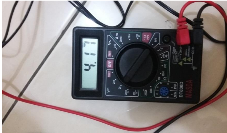
Gambar 4.6 Hasil pengukuran tegangan photo interrupter dengan halangan
