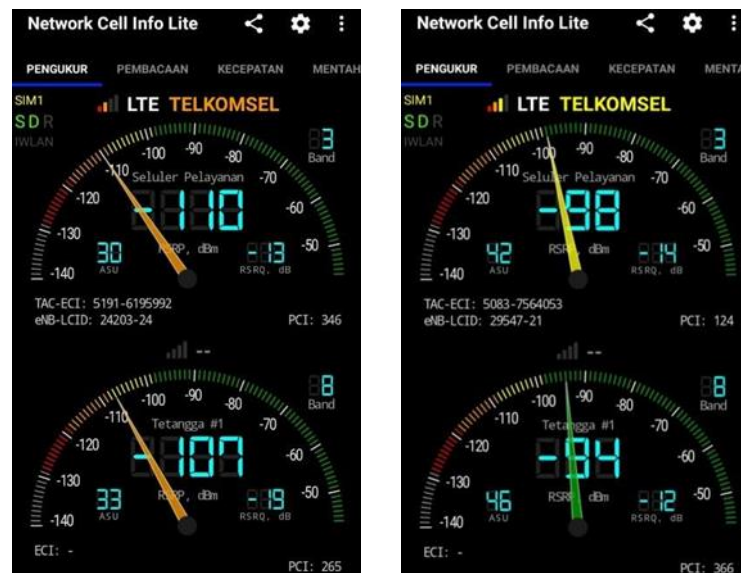
Gambar 9. Pengujian Jaringan LTE Telkomsel Sebelum dan Sesudah Antena
