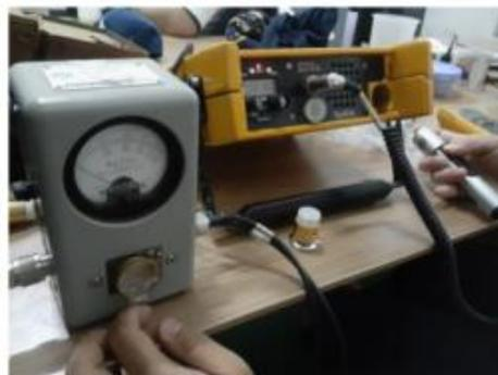
Gambar 3. Pengukuran power pancar dengan wattmeter
