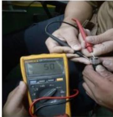
Gambar 4. Pengukuran impedansi
