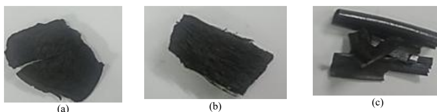
Gambar 3: Sampel hasil pirolisis (a) Arang Cangkang Kelapa, (b) Arang Sabut Kelapa, dan (c) Arang Daun Kelapa
