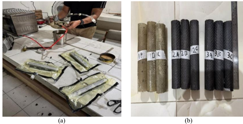
Gambar 1: (a) Proses pembuatan spesimen komposit profil hollow tube dan (b) Hasil produk komposit
