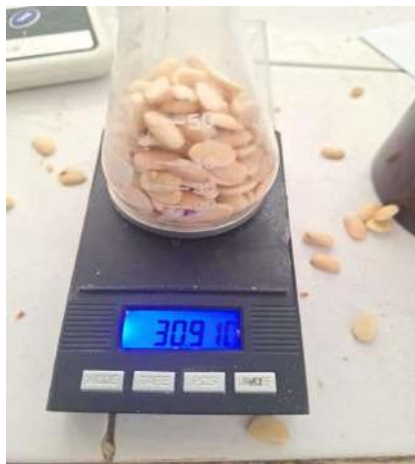
Gambar 2: Pengukuran masa dan volume butiran kedelai matang
