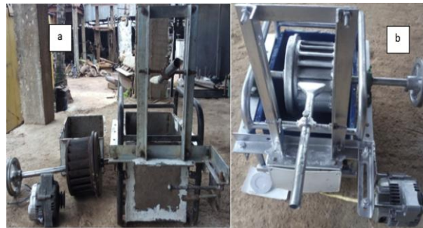
Gambar 6: (a) Bagian-bagian turbin yang difabrikasi (b) Turbin aliran silang yang telah dirakit (Achebe dkk., 2020)
