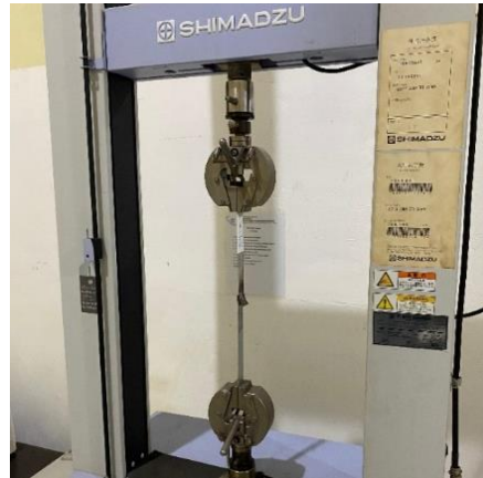
Gambar 4: Proses pengujian kekuatan geser pada mesin UTM
