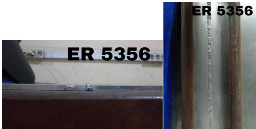
Gambar 3: Hasil pengelasan menggunakan filler ER 5356
