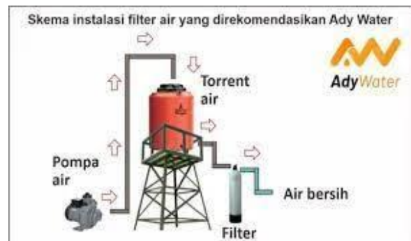
Gambar 3. Instalasi Filter air yang akan terpasang
