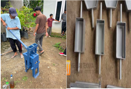
Gambar 2. Mesin cetak dan cetakan paving block manual
