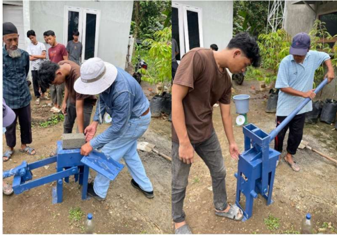
Gambar 4. Proses pembuatan paving block di lapangan
