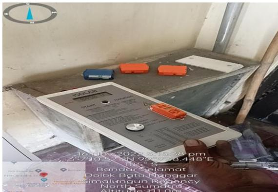
Gambar 4. Pengukuran tahanan isolasi *surge arrester* di Kantor Besar
