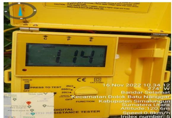
Gambar 7. Hasil pengukuran nilai tahanan *grounding* di Jembatan Timbang 40 dan 50 ton
