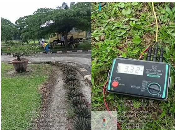
Gambar 3. Hasil pengukuran nilai tahanan grounding di Kantor Besar
