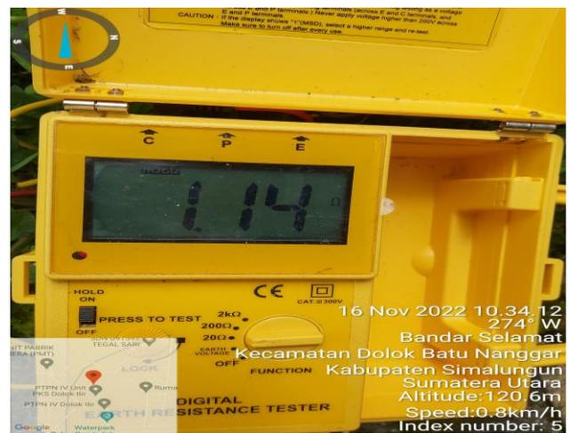
Gambar 7. Hasil Pengukuran Nilai Tahanan Grounding di Jembatan Timbang 40 dan 50 Ton
