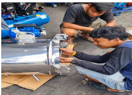
Gambar 9. Perakitan slinder luar
