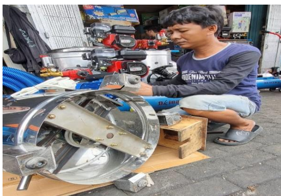
Gambar 8. Perakitan motor listrik untuk spinner
