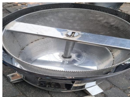
Gambar 7. Pemasangan slinder dalam
