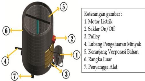
Gambar 6. Desain struktural mesin spinner
