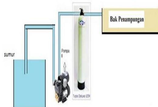
Gambar 6. Instalasi filter air yang dipasang
