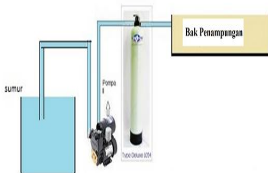
Gambar 6. Instalasi Filter air yang dipasang
