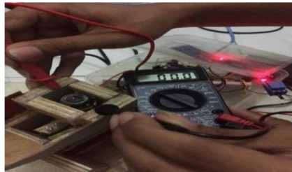
Gambar14. Pengukuran Motor DC Padasaat Relay Tidak Aktif
