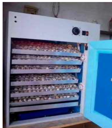
Gambar 3b. Inkubator Penetas Telur dengan kontrol berbasis elektronika
