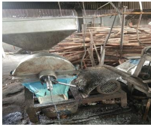
Gambar 2. Mesin Penggiling Kedelai Menghasilkan Air Perasan Kedelai sebagai bahan baku tahu
