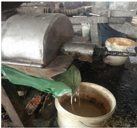
Gambar 2. Mesin Penggiling Kedelai Menghasilkan Air Perasan Kedelai sebagai bahan baku tahu
