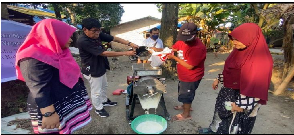
Gambar 3.2. Uji coba pengoperasian mesin penggiling kacang kedelai
