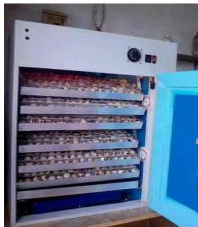
Gambar 3b. Inkubator Penetsa Telur dengan kontrol berbasis elektronika
