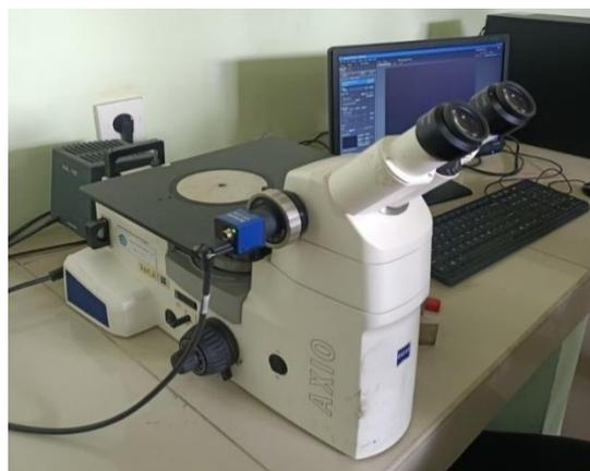
Gambar 3. Alat Uji Foto Mikroskop ZEISS A×IO Vert.A1
