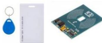
Gambar 1. RFID tag dan RFID reader
