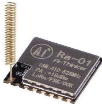
Gambar 3. Bentuk Fisik LoRa Ra01
