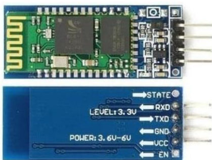
Gambar 2. Bentuk Fisik dan Pin Out Modul Bluetooth HC-06 Sumber: Oktavia Fajarianti, 2020
