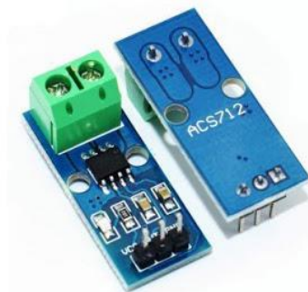
Gambar 3 Sensor ACS712 Sumber: Tromis, 2021
