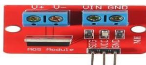
Gambar 15. Bentuk Fisik Mosfet Modul
