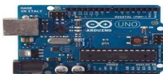
Gambar 1. Bentuk Fisik Arduino Uno
