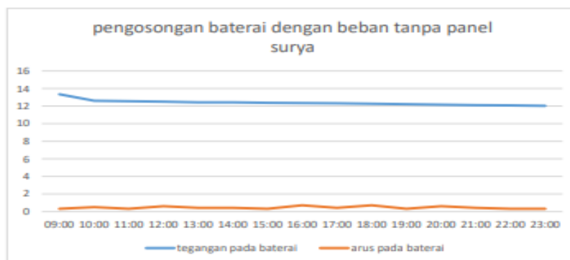
Gambar 6. Grafik Pengosongan Baterai Dengan Beban Tanpa Panel Surya
