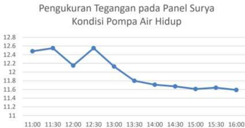
Gambar 5. Grafik Pengukuran Tegangan pada Panel Surya Kondisi Pompa Air Hidup
