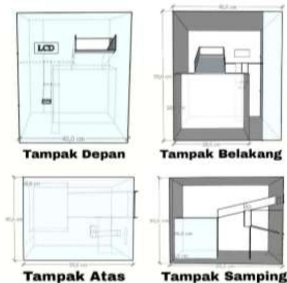
Gambar 8. Desain Tempat Sampah atau Casing Mesin
