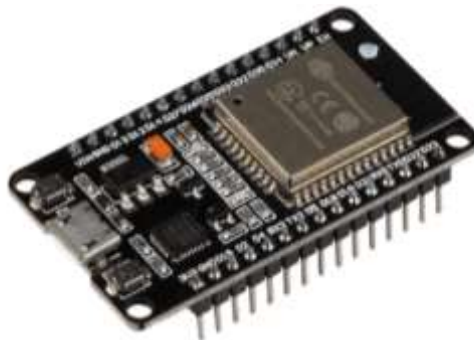
Gambar 4. Mikrokontroler ESP32 (Sumber : Espressif System,2020)
