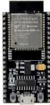
Gambar 2. NodeMCU ESP 32
