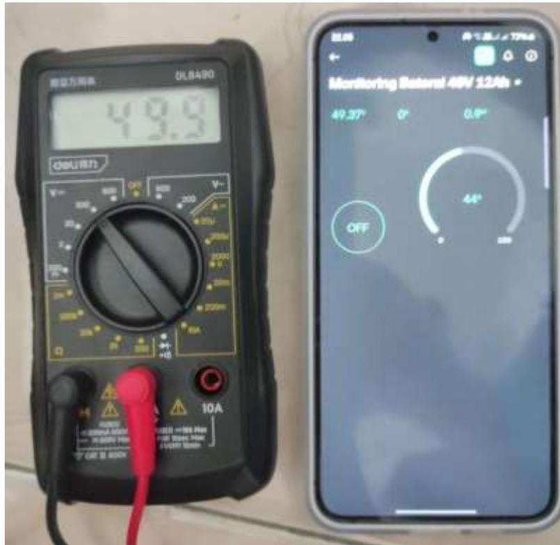
Gambar 9. Perbandingan Pengukuran dengan Multimeter dan Program *Monitoring* Blynk
