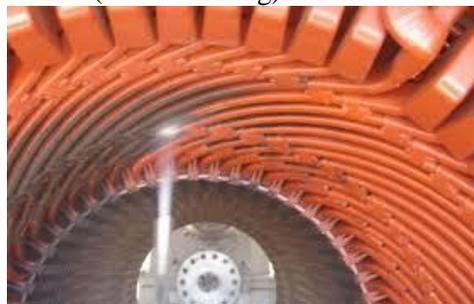
Gambar 3. Konstruksi Stator Generator
