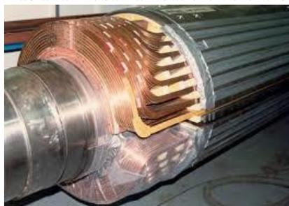
**Gambar 2.** Konstruksi Rotor Generator
