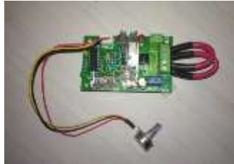
Gambar 6. PWM module 20A Sumber : Riyan, 2023
