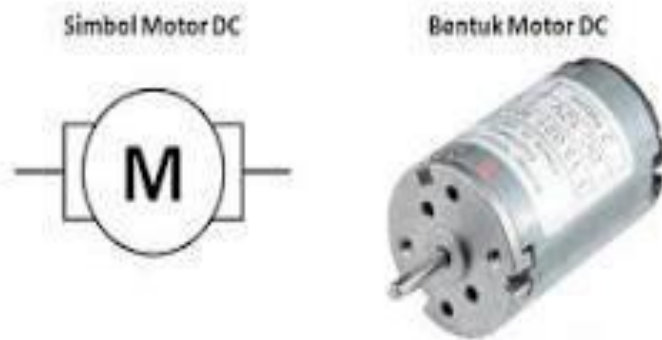
Gambar 3. Bentuk Fisik dan Simbol Motor DC Sumber: Dalope, 2019
