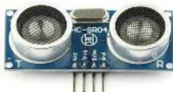
Gambar 2. Sensor *ultrasonic*
