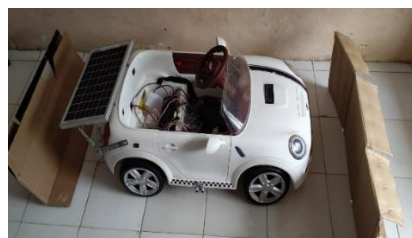
Gambar 24 Ada Penghalang di Sensor Belakang dan Depan (Sumber: Penulis)
