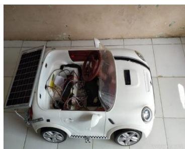
Gambar 18 Ada Penghalang di Sensor Kiri (Sumber: Penulis)
