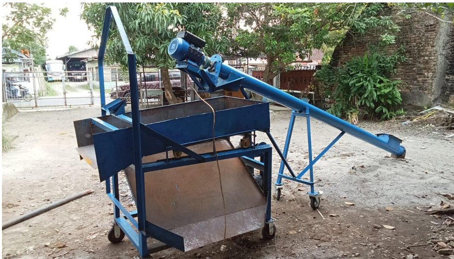
Gambar 2. Mesin ayakan pasir dan pesawat angkat pasir.
