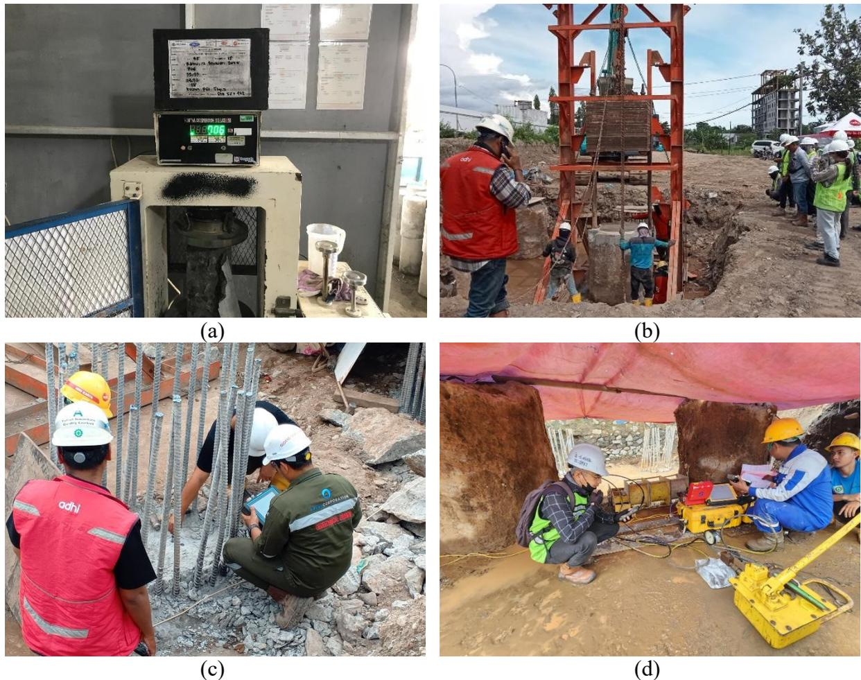
Gambar 2. Pelaksanaan *Quality Control* Pekerjaan *Bored Pile* (a) Uji Kuat Tekan Beton ; (b) *PDA Test* ; (c) *PIT Test* ; (d) Tes Lateral
