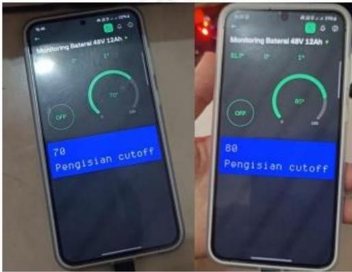
Gambar 6. Pengujian auto cutoff
