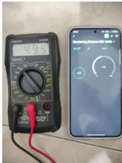
Gambar 5. Pengujian Monitor Voltase dengan Aplikasi Blynk
